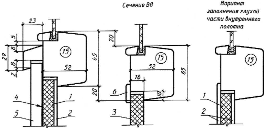
1 - мягкая ДВП толщиной 12 мм по ГОСТ 4598; 2 - твердая ДВП марки Т группы А толщиной 3,2-4 мм по ГОСТ 4598; 3 - шлифованная ДСП толщиной 16 мм по ГОСТ 10632; 4 - пергамин по ГОСТ 2697; 5 - обшивка типа О-2 по ГОСТ 8242; 6 - раскладка
