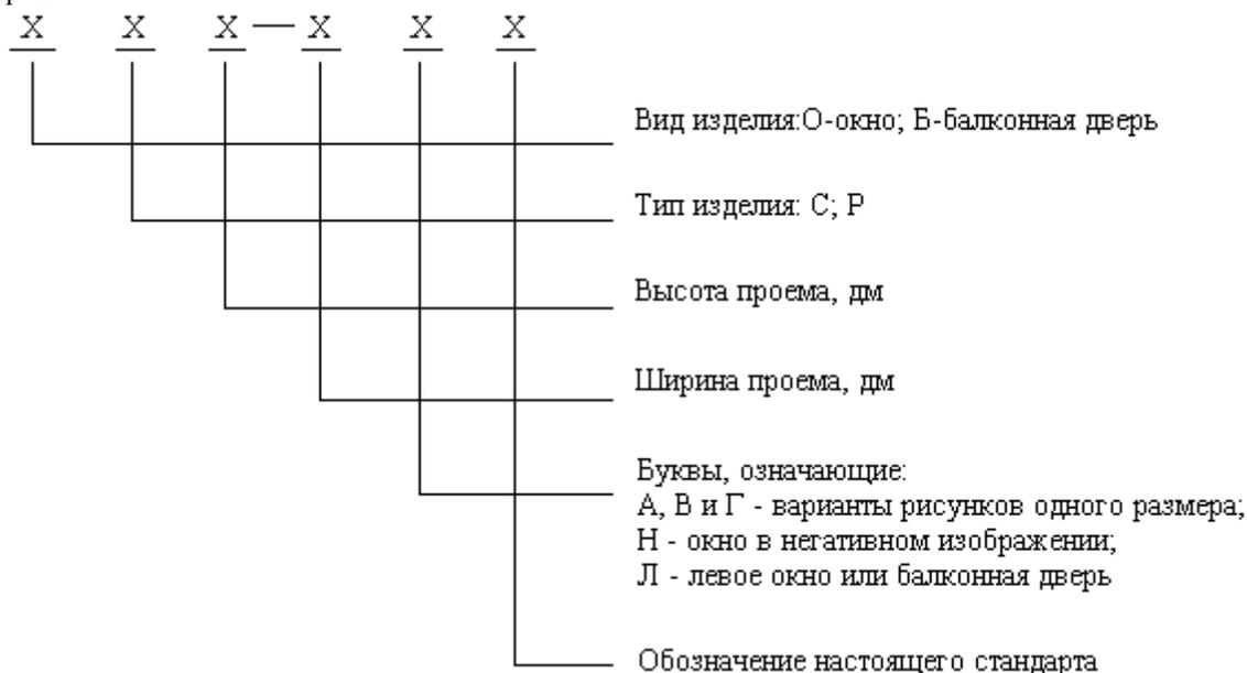
В конце марки окон и балконных дверей с одинарным остеклением, перед обозначением стандарта, добавляют цифру 1 через тире.
