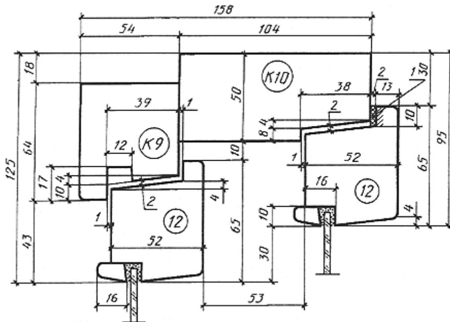
Примечание. Допускается размеры штапика уменьшать на 1 мм.
