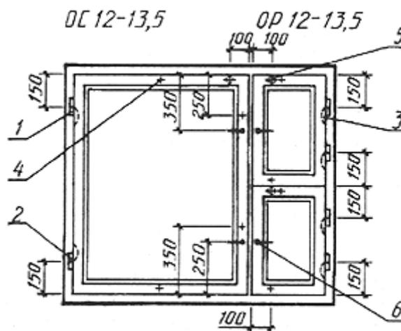
4. Ручки РС80 устанавливают на наружных створках с внешней стороны здания на высоте 1000 мм от порога.
